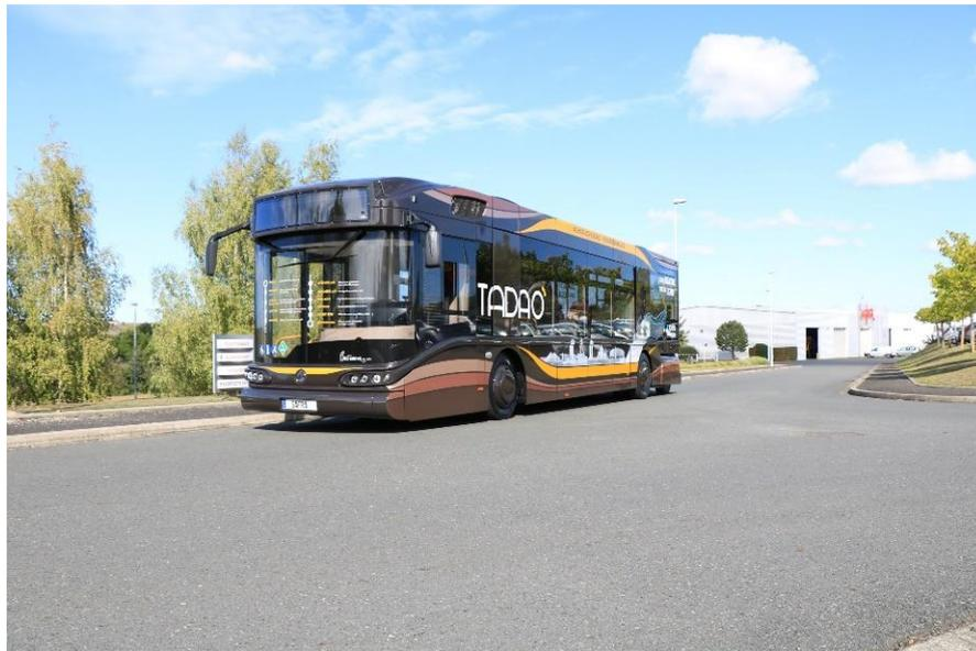
**Une motorisation composée d'un moteur électrique puissant (250 kW) alimenté par un pack batterie de capacité importante (132 kWh), le tout associé à une pile à combustible de 30 kW qui permet d'augmenter l'autonomie à plus de 350 km.**
